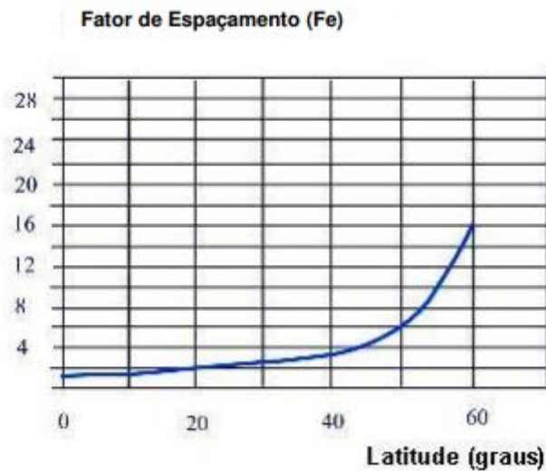
Figura 12 - Variação do fator de espaçamento em relação à latitude de instalação.
