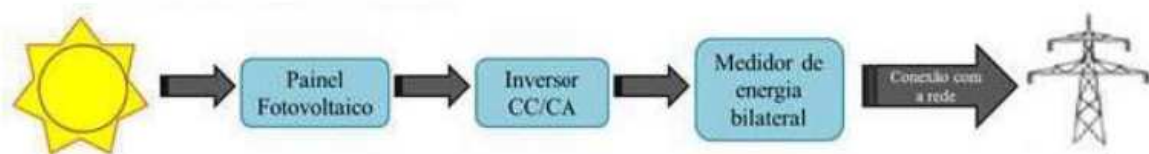
Figura 28: Sistema solar fotovoltaico conectado à rede.
