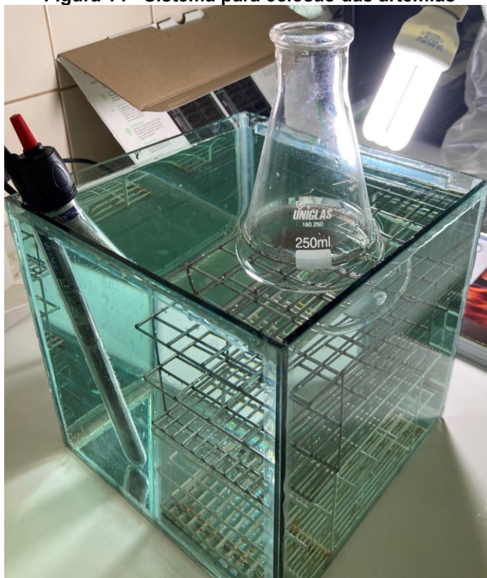
Figura 14 - Sistema para eclosão das artêmias
