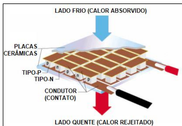
Figura 16 – Transferência de calor na pastilha de Peltier
