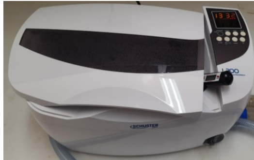
Figura 11 - Cuba Ultrassônica Schuster L300
