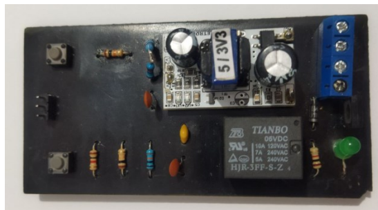
Figura 25 - Parte superior da PCI final do projeto com os componentes soldados
