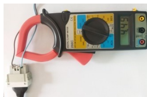
Figura 18 - Amperímetro comercial usado para calibração e coleta de dados de corrente dos equipamentos testados
