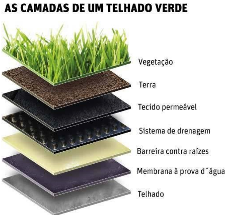
Figura 5 — Estrutura telhado verde
