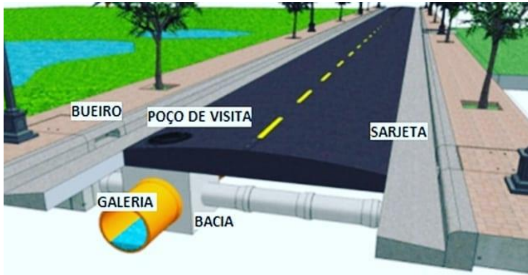
Figura 2. Representação de componentes da rede de drenagem urbana.
