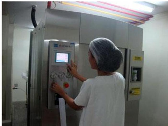
**FIGURA 4 – Controlador Microprocessado de Autoclave à Vapor de Formaldeído**
