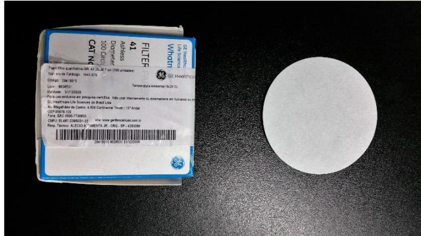
**Figura 2: Filtro de Papel, diâmetro de 70 mm, para análise residual do Formaldeído**
