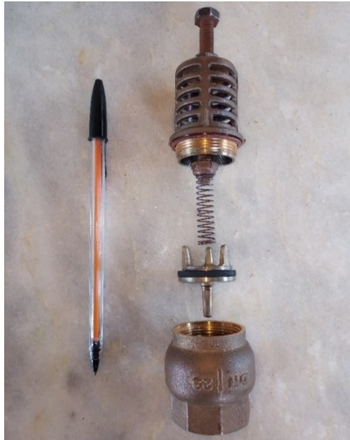
Figura 25 – Detalhe da válvula de impulso adaptada e suas partes
