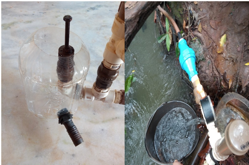
Figura 28 – Dispositivo de coleta da vazão q_4 (à esquerda) e coleta da vazão q_4 em andamento (à direita)
