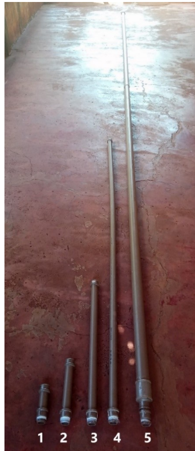
Figura 27 – Câmaras fabricadas com diferentes volumes: câmara 1(0,070L), câmara 2 (0,140L), câmara 3 (0,380L), câmara 4 (1,220L), câmara 5 (9,000L)
