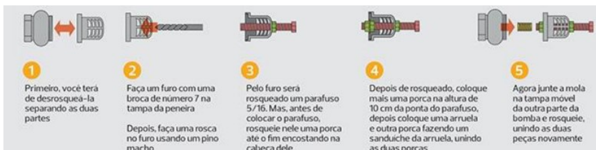
Figura 24 – Desenho esquemático de montagem da válvula de impulso modificada
