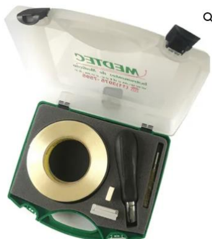
Figura 10 - Teste de Aderência em Grade
