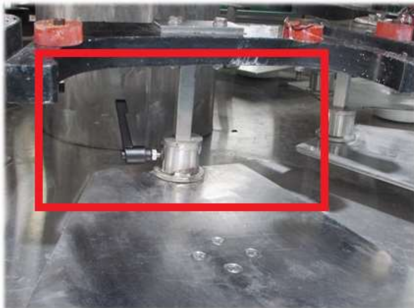
Figura 16: Após a instalação do manípulo
