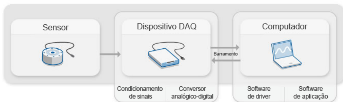
Figura 3 – Partes do sistema de aquisição de sinais
