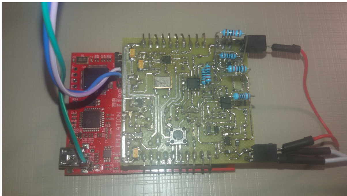
Figura 10 – PCI do sistema de aquisição conectada ao kit MSP430 Fonte: Autoria própria
