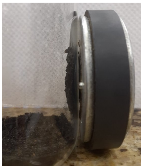
Figura 17 – Verificação das propriedades magnéticas do CAM 500
