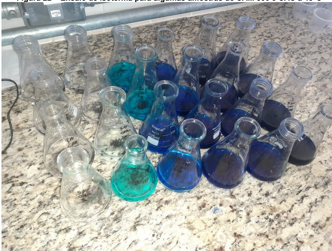
Figura 22 – Ensaio de isoterma para algumas amostras de CAM 500 e CAC a 45°C
