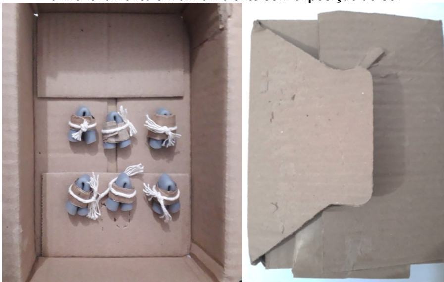
Figura 10 - Corpos de prova da amostra EL-2N durante o a simulação de armazenamento em um ambiente sem exposição ao sol
