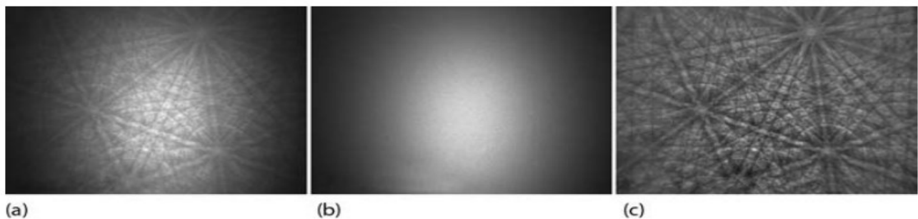
Figura 9: Padrões EBSD a) difração de carbeto de tungstênio obtida sem filtros; b) sinal do Background; c) padrão com remoção do Background.
