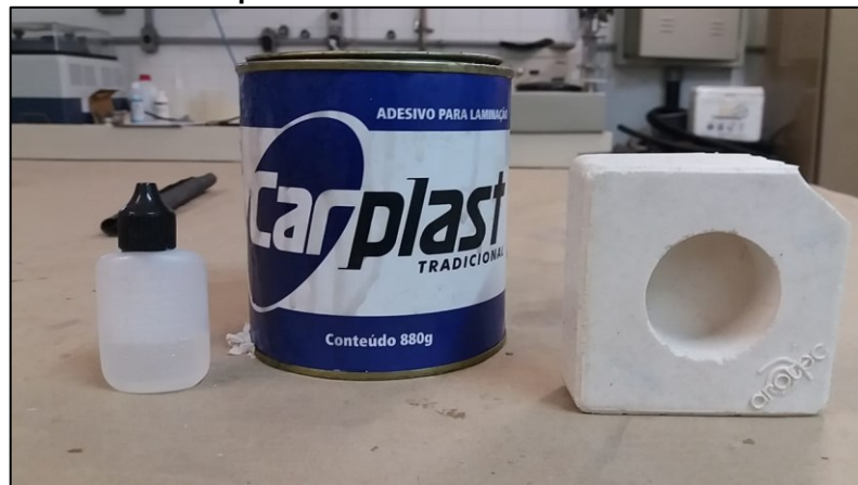
Figura 14: Insumos utilizados no embutimento. Da esquerda para a direita: catalisador, resina poliéster e molde de silicone.
