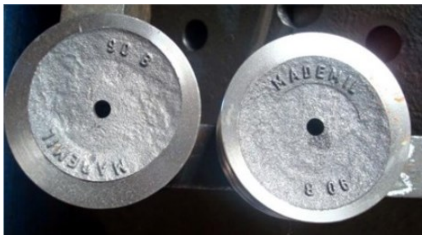
Figura 7 – Desvio dimensional ocasionado pelo encaixe mal feito do molde
