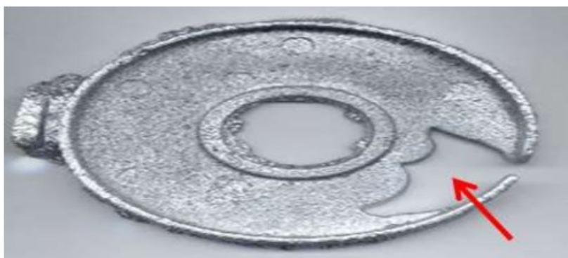
Figura 8 – Peça fundida apresentando falta de preenchimento
