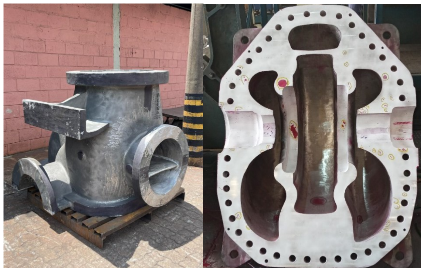
Figura 23 – Conjunto de carcaças utilizada para bombeamento de água
