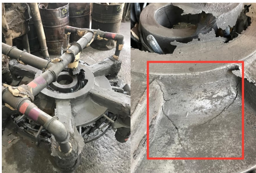
Figura 28 – Rotor de Sucção com trincas após tratamento térmico
