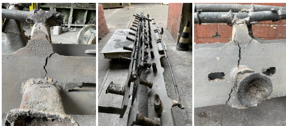
Figura 40 – Suportes de tubo com trincas nas regiões próximas aos massalotes e canais de ataque
