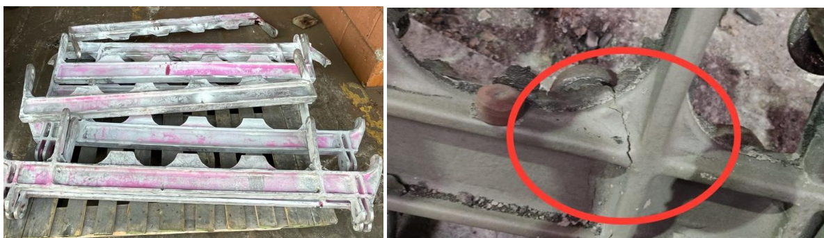
Figura 18 – Suportes de fornos modelos F-7 e F-8 fabricado em HK40
