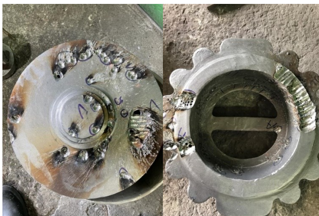
Figura 44 – Peças com poros devido erro durante desoxidação do banho metálico
