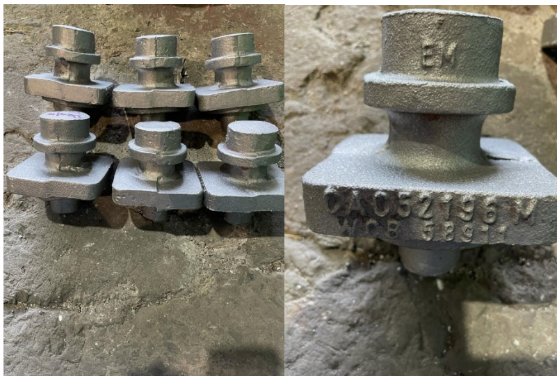
Figura 36 – Castelos com deslocamentos devido à utilização de guias inadequadas
