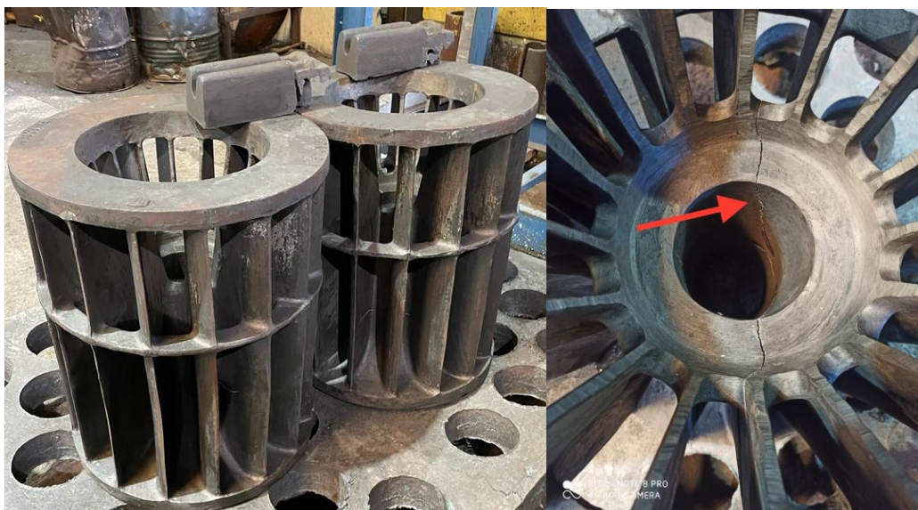
Figura 27 – Rotores com trincas na região interna após tratamento térmico
