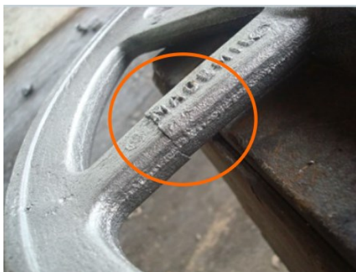
Figura 6 – Peça fundida com trinca na região de menor espessura
