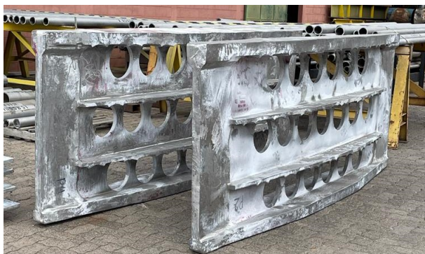
Figura 24 – Suporte de tubos utilizados em fornos petroquímicos
