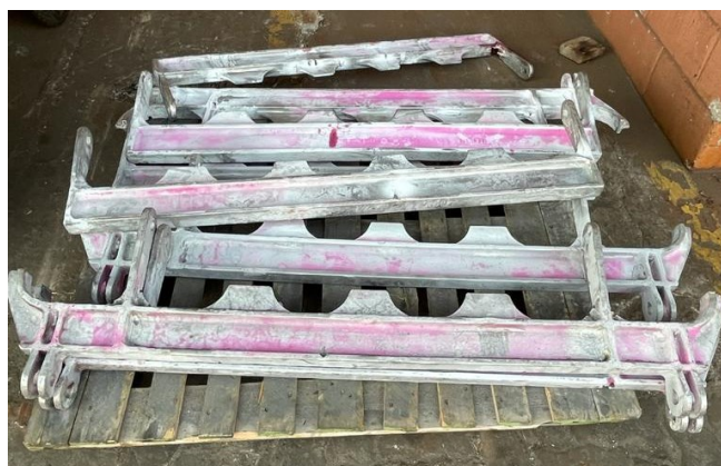
Figura 26 – Suportes utilizados em fornos petroquímicos após ensaio de líquido penetrante
