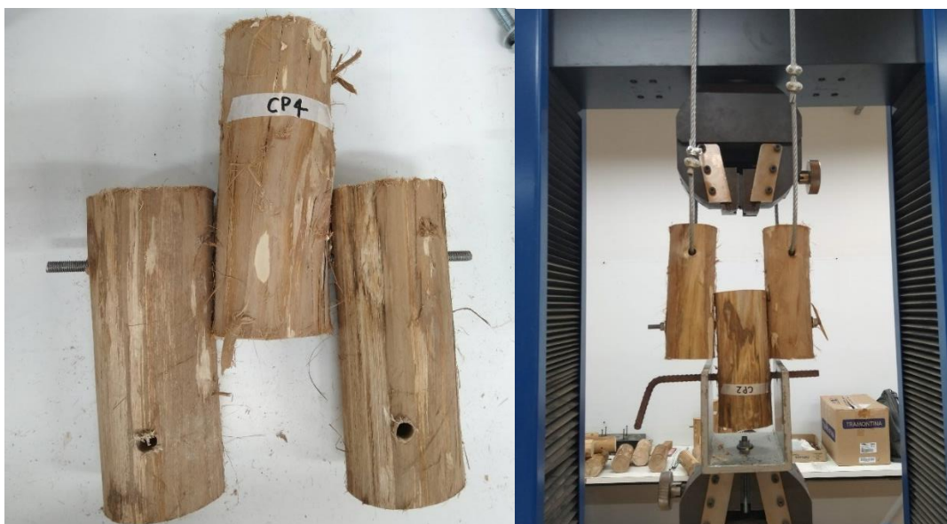
Figura 38: Configuração final dos corpos de prova presos por cabos de aço para os ensaios de ligação paralela Fonte: Autoria própria (2019).
