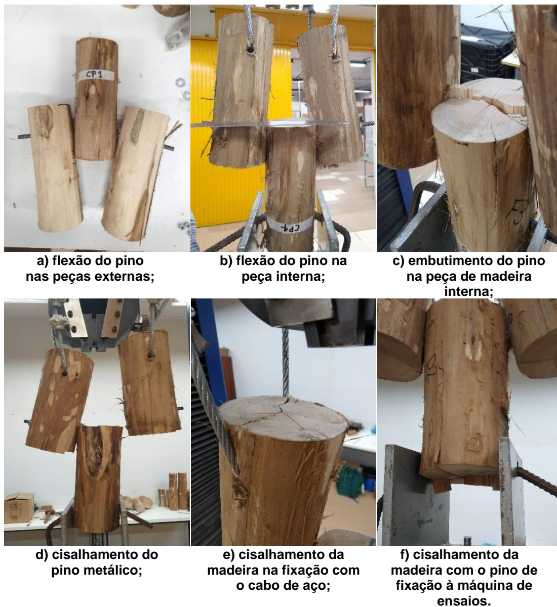
Figura 40: Ensaio de ligação paralela às fibras Fonte: Autoria própria (2019).
