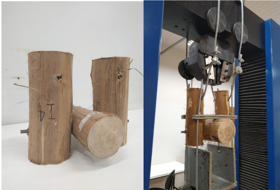
Figura 39: Configuração final dos corpos de prova presos por cabos de aço para os ensaios de ligação normal.
