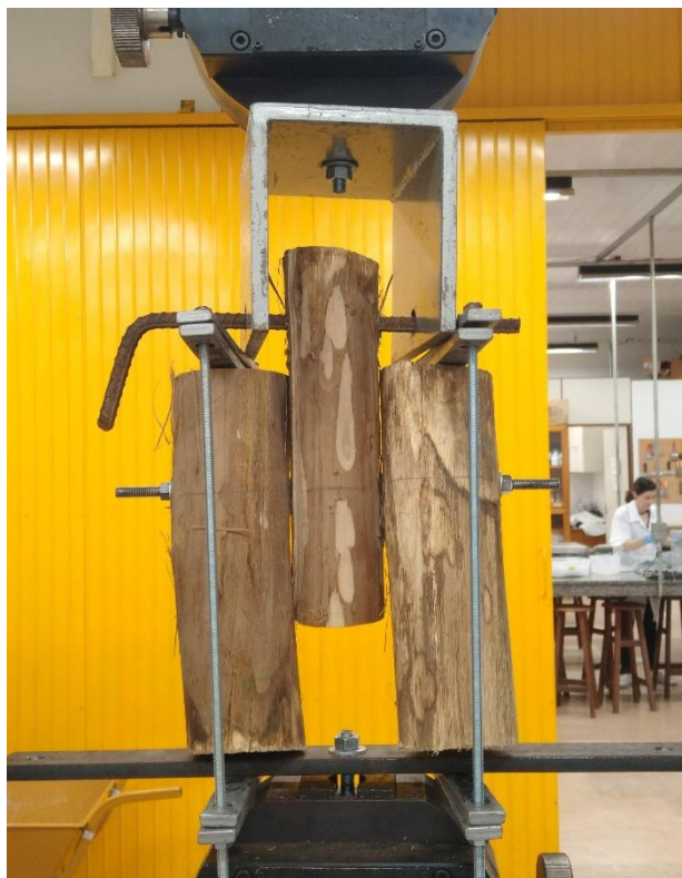
Figura 37: Detalhes do segundo ensaio experimental da ligação paralela Fonte: Autoria própria (2019).
