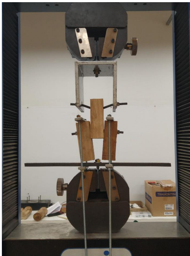
Figura 36: Detalhes do primeiro ensaio experimental da ligação paralela Fonte: Autoria própria (2019).
