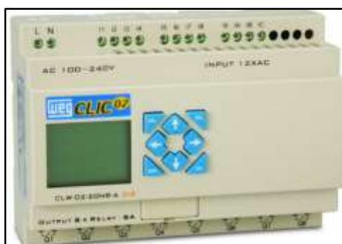
Figura 6: Controlador Lógico Programável - CLP
