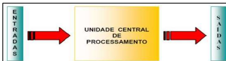
Figura 7: Estrutura básica de funcionamento de um CLP
