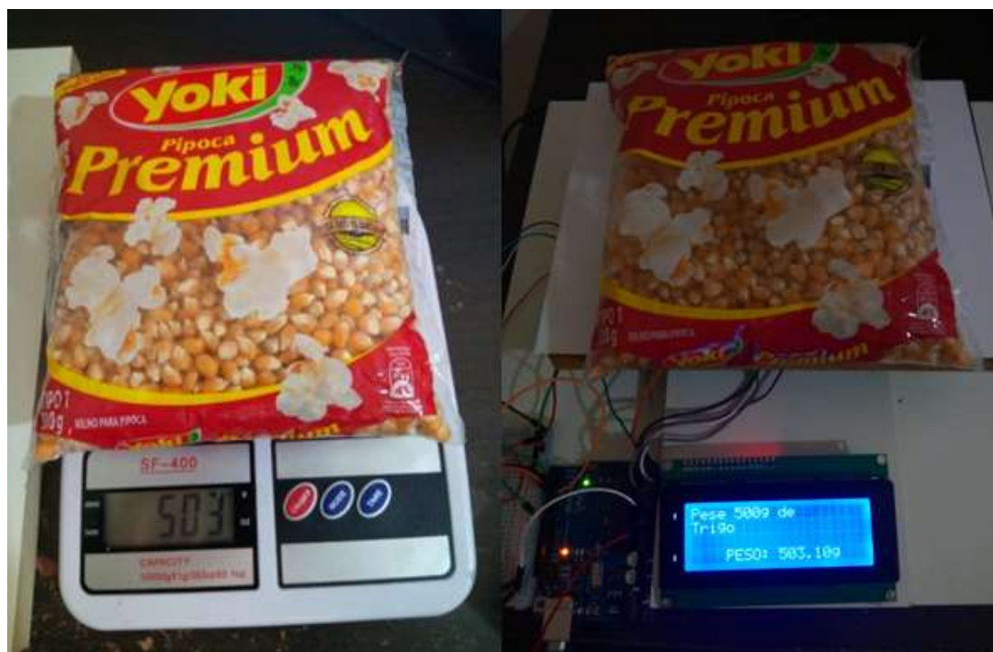
Figura 21: Calibração confirmada com a Balança Arduino
