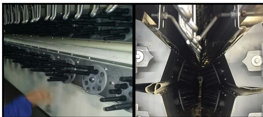
Figura 5: depenadeiras em linha e dedos de borracha Fonte: autoria própria
