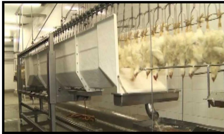
Figura 4: cuba de imobilização por eltronarcose Fonte: autoria própria
