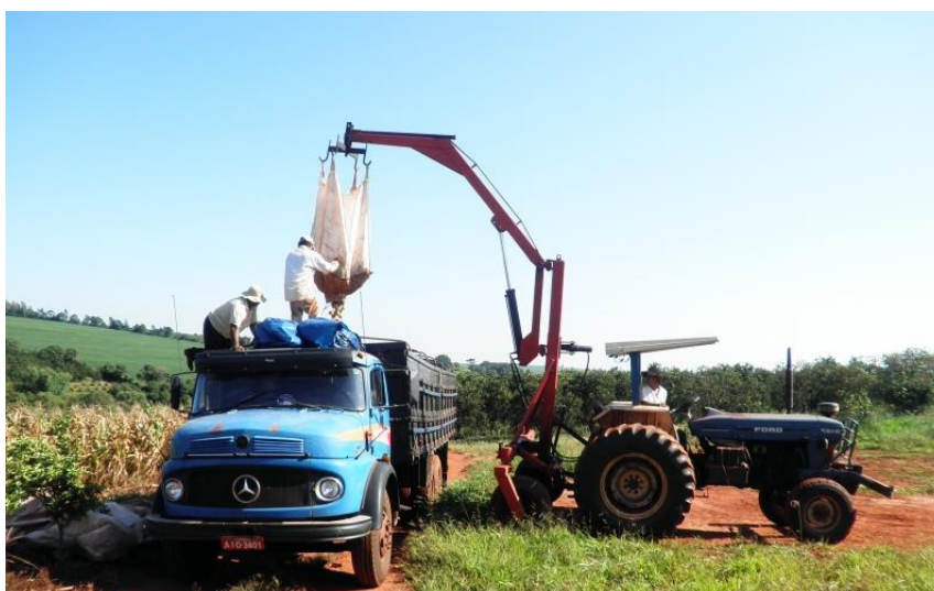
Figura 15 - Trator com guincho traseiro Fonte: Ast Metal
