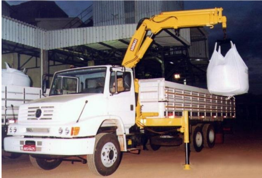
Figura 14 - Guindaste hidráulico movimentando bag Fonte: Rodomaq
