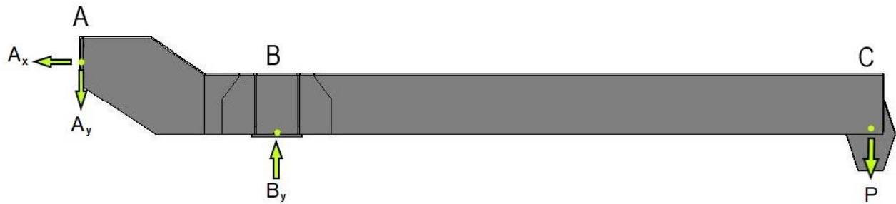
Figura 24 - Diagrama de corpo livre Fonte: Autoria própria
