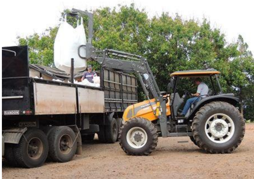
Figura 16 - Trator com guincho dianteiro Fonte: Stara
