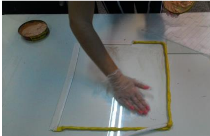
Figura 10 - Delimitação do perímetro da bolsa de vácuo e aplicação de cera a base de carnaúba na superfície do vidro
