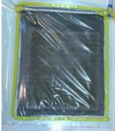
Figura 18 – Bolsa concluída sem a ação da bomba de vácuo
