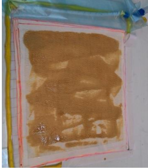
Figura 14 - PU vertida sobre a primeira parte das lâminas de FA
