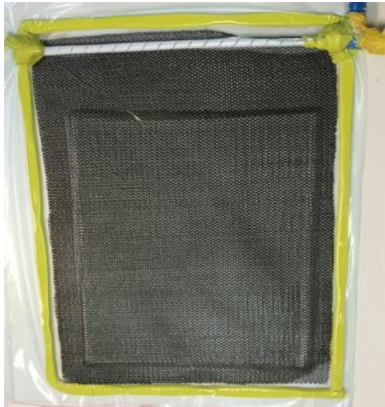
Figura 19 – Bolsa com a bomba de vácuo acionada
