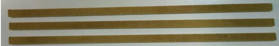
Figura 20 - Corpos de prova obtidos através do corte da placa de PU + FA
