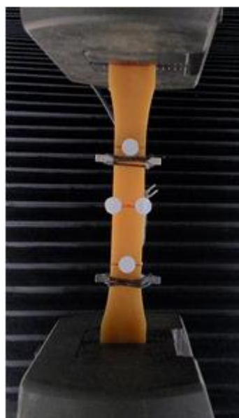
Figura 21 – Imagem ilustrativa da marcação de pontos na superfície do CDP
