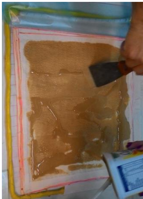
Figura 15 - Segunda parte das lâminas de FA impregnadas com PU
