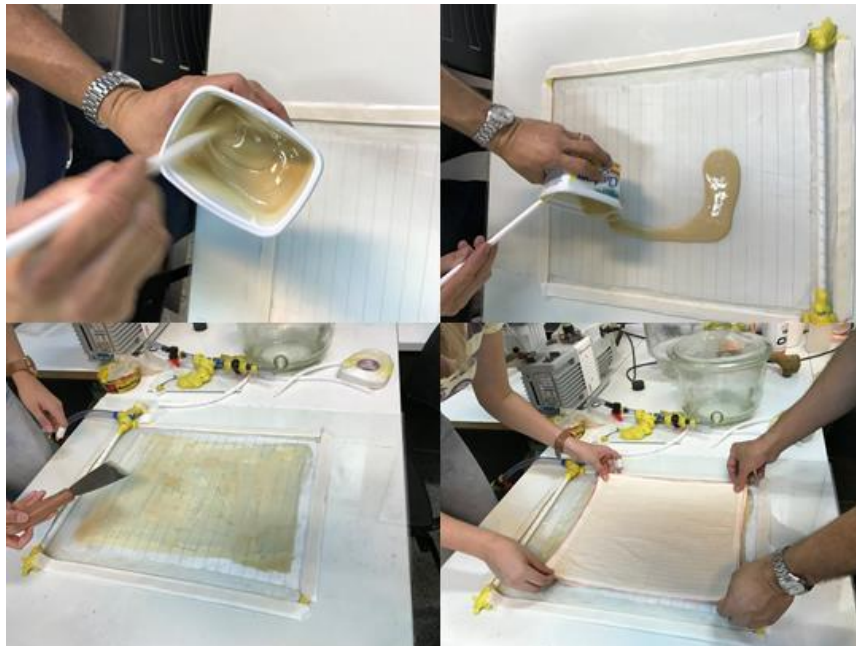
Figura 13 - Distribuição da PU sobre o Peel Ply e posicionamento das lâminas de FA
