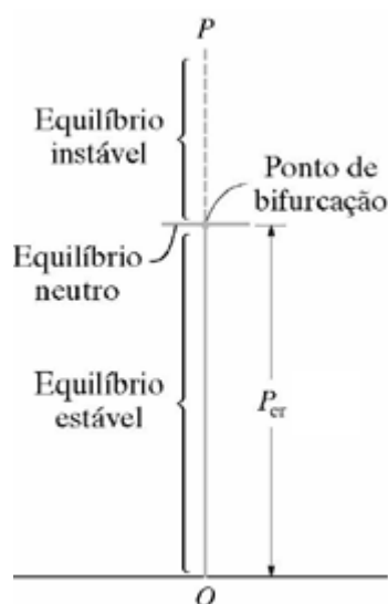
Figura 3 - Diagrama de equilíbrio para flambagem de uma estrutura Fonte: HIBBELER (2010, p. 478)
