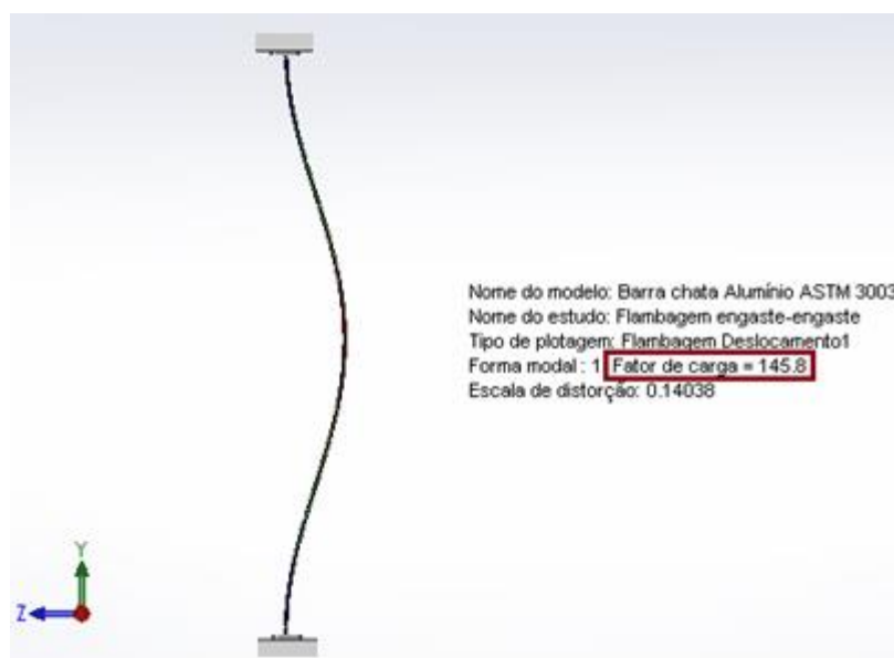
Figura 15 - Carga crítica de flambagem em Newtons para a coluna engastada-engastada Fonte: Autoria própria
