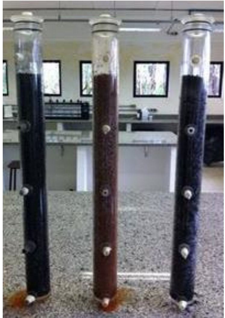
Figura 3. Filtros de plexiglass - a) Esquema com as medidas; b) Da esquerda para a direita: filtros com meio suporte carvão, cerâmica de argila e borracha de pneu respectivamente. Fonte: Autoria própria, 2015.
