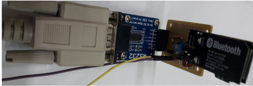
Figura 16: Parte do sistema ligado ao conversor RS232 board sem o uso do display LCD (com uso da fonte de tensão).
