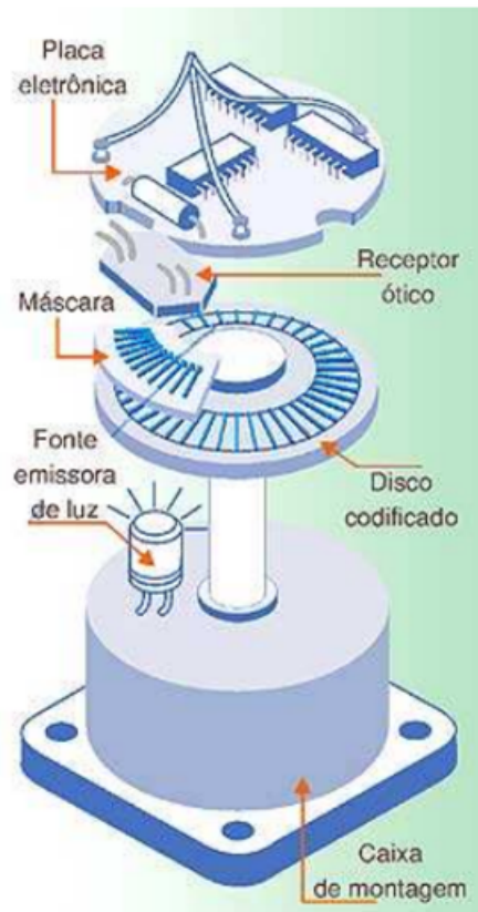
Figura 3: Constituição física do encoder.
