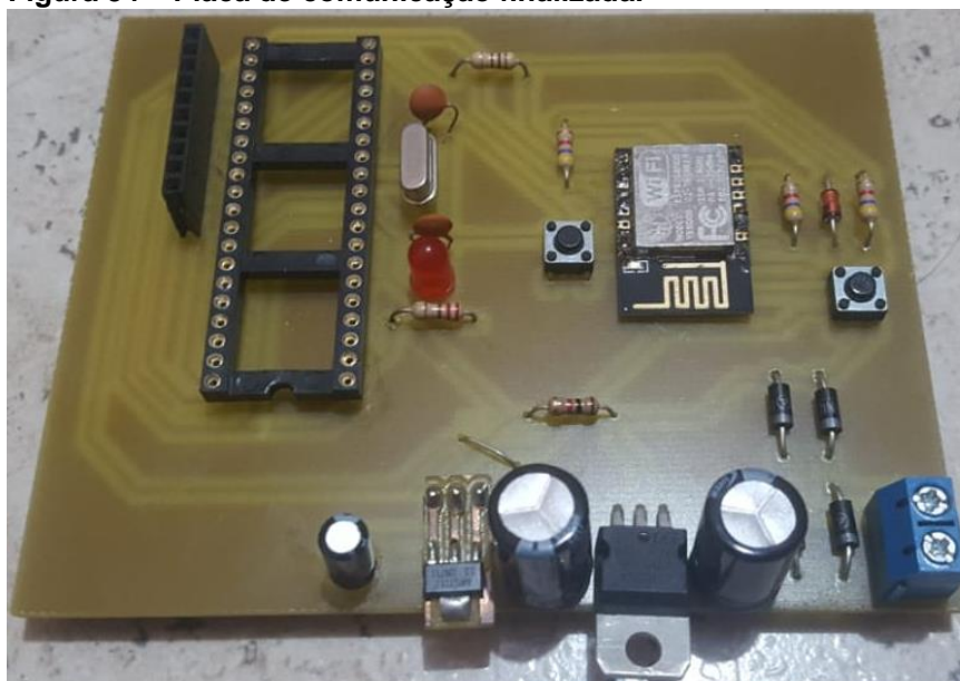
Figura 34 – Placa de comunicação finalizada.
