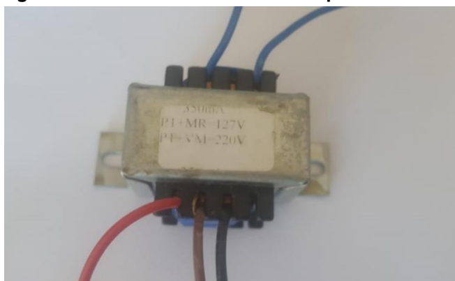
Figura 18 – Transformador 110/220V para 9V.
