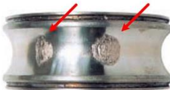
Figura 3 – Falha do tipo degradação localizada.
