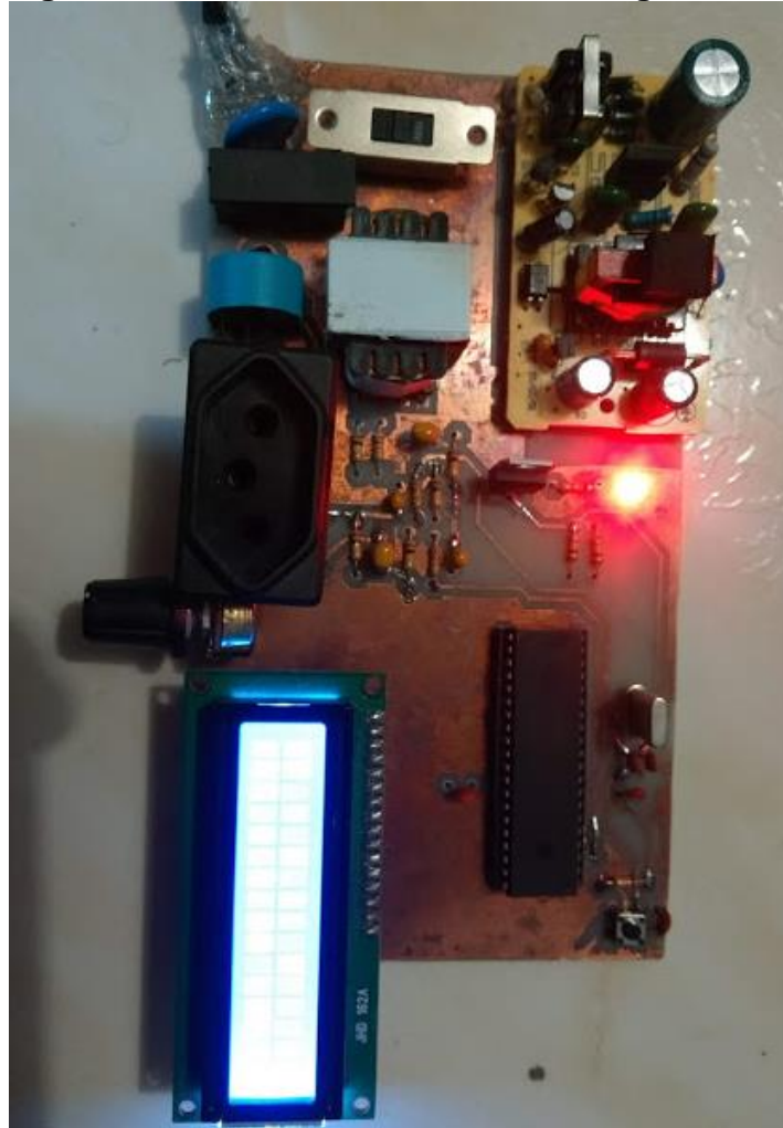
Figura 29 – Placa do medidor de energia
