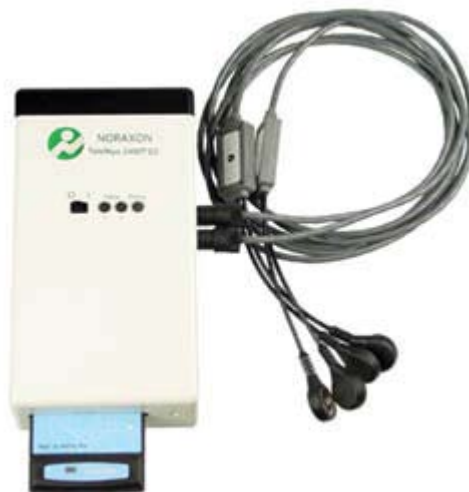
Figura 3.4: Eletromiógrafo de 8 canais TeleMyo 2400 TG2. Fonte: Camata (2011)
