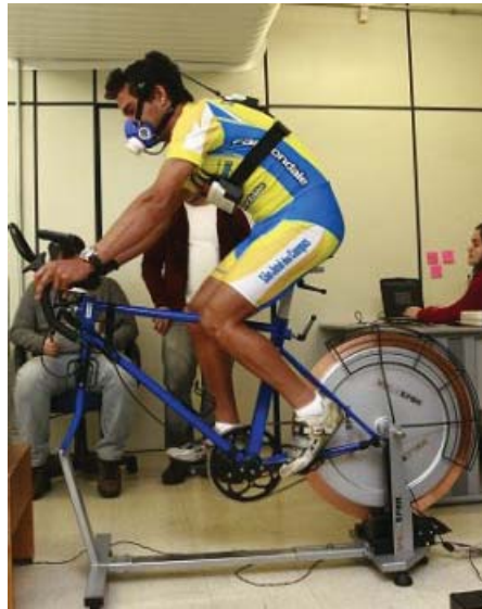
Figura 3.1: Ciclossimulador modelo Velotron DYNAFIT (Racer Mate, USA). Fonte: Camata (2011)
