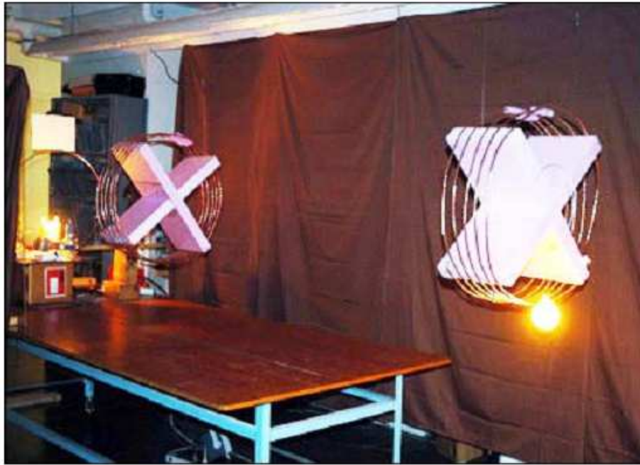
Figura 1 – Protótipo do MIT para iluminar uma lâmpada de 60 W. Fonte: Miguel; Bonifácio (2009).
