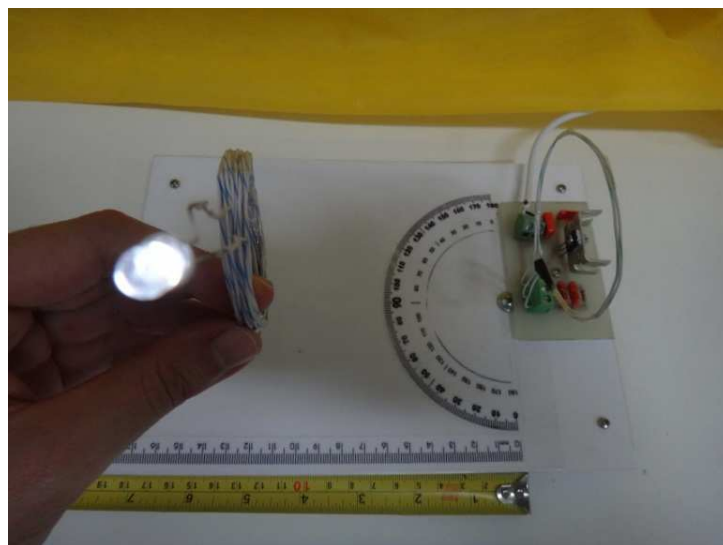
Figura 25 – Bobina primária de fio branco com verde na situação 4, com luminosidade mínima. Fonte: Autoria própria.
