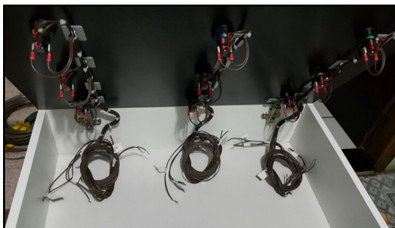
Figura 10 – Estimulador visual eletrônico aberto (com instalação interna) Fonte: Autoria própria
