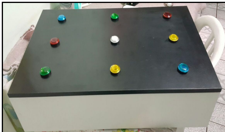
Figura 8 – Estimulador visual eletrônico fechado (com botoeiras de leds embutidas, sem instalação interna) Fonte: Autoria própria.
