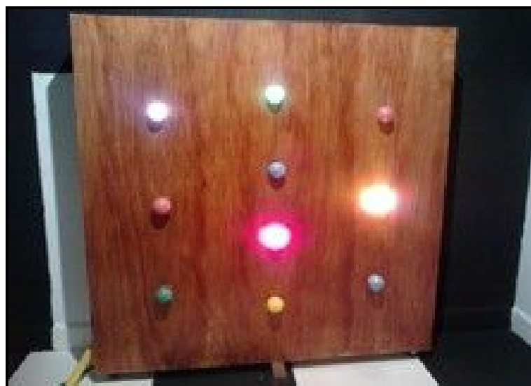
Figura 4 - Estimulador visual com leds existentes no mercado Fonte: http://www.associacaopode.org/noticias.php
