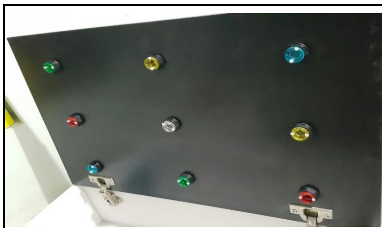
Figura 9 – Estimulador visual eletrônico aberto (com botoeiras de leds embutidas) Fonte: Autoria própria.
