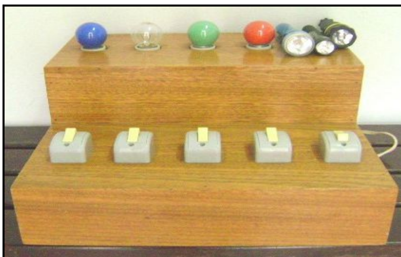
Figura 3 - Estimulador visual com lâmpadas incandescentes existentes no mercado
