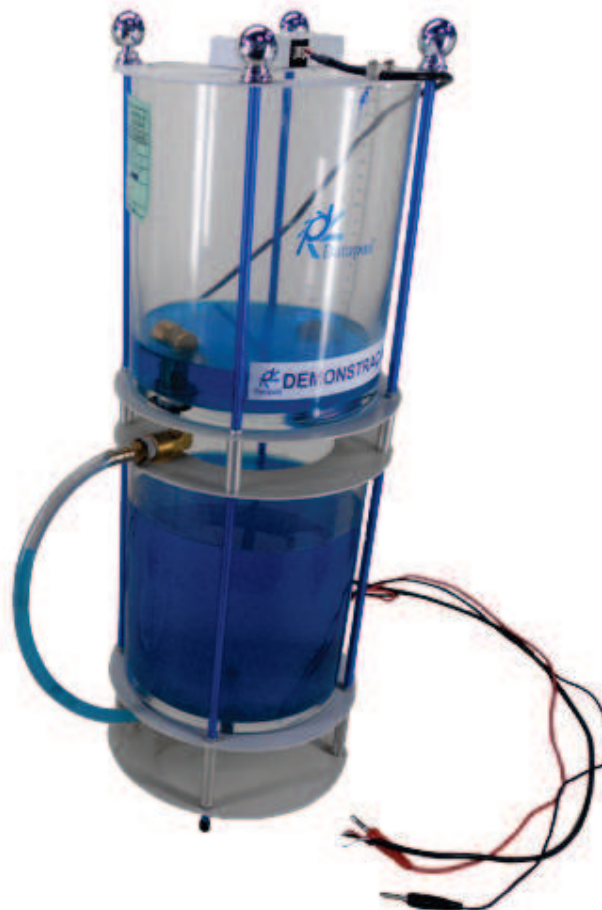
Figura 11 – Reservatório de líquido do Módulo de Nível e Temperatura 2325 Datapool. Fonte: Datapool (2003b)
