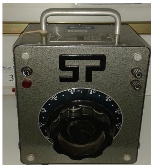
Figura 3 – Transformador variador de tensão (variatic).
