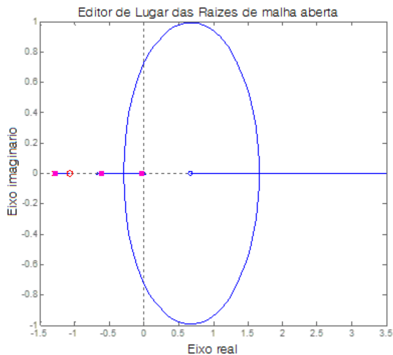
Figura 22: Diagrama de Root Locus com compensador avanço de fase. Fonte: Autoria própria.
