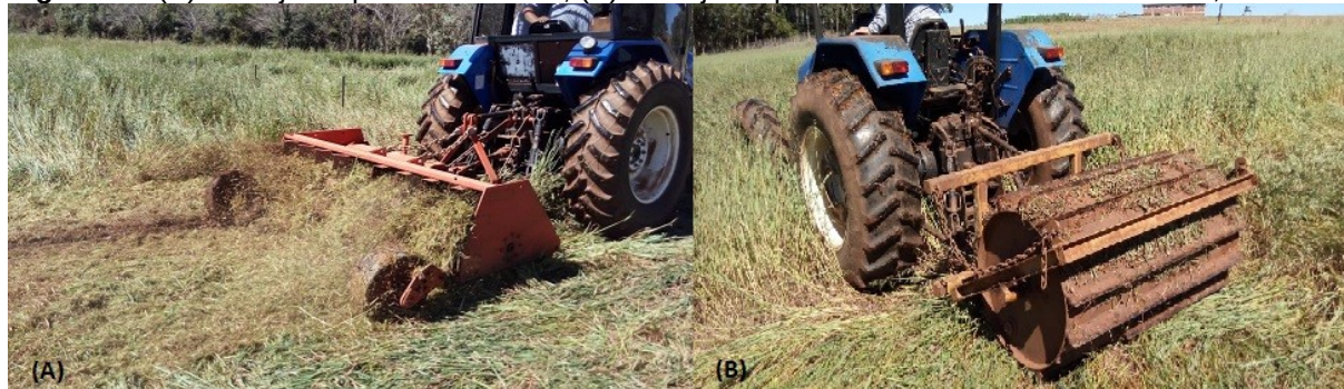
Figura 2 – (A) Manejo da palha com tritor; (B) Manejo da palha com rolo faca. Pato Branco, 2020.
