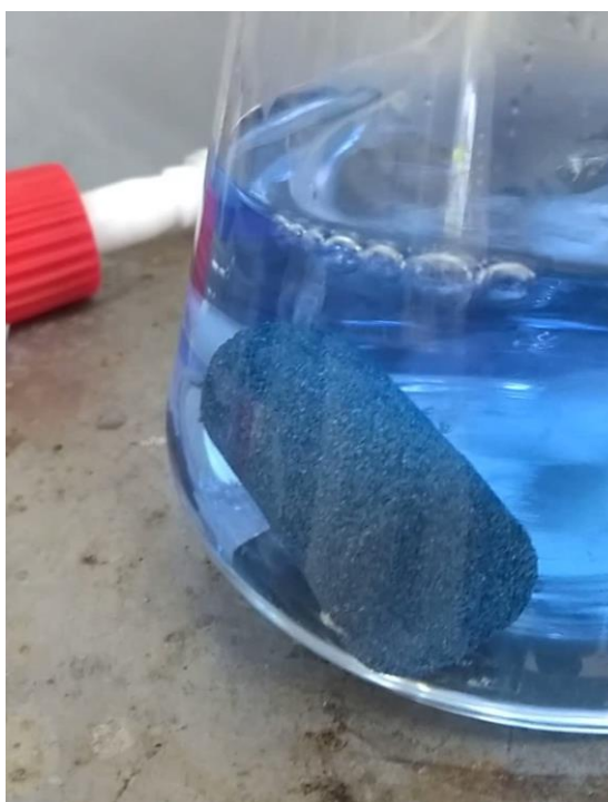
Figura 6 - Microbolhas sendo dispersadas no meio reacional de Índigo
