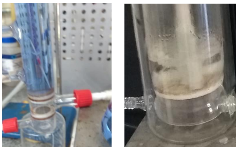
Figura 7 - Placa porosa difusora de microbolhas
