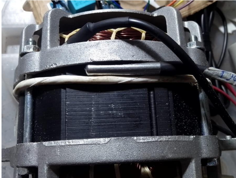
Figura 19- Sensor de temperatura acoplado na carcaça do motor. Fonte: Autoria própria.
