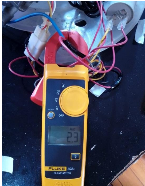
Figura 33- Leitura de corrente pelo multímetro Fluke 302+. Fonte: Autoria própria.
