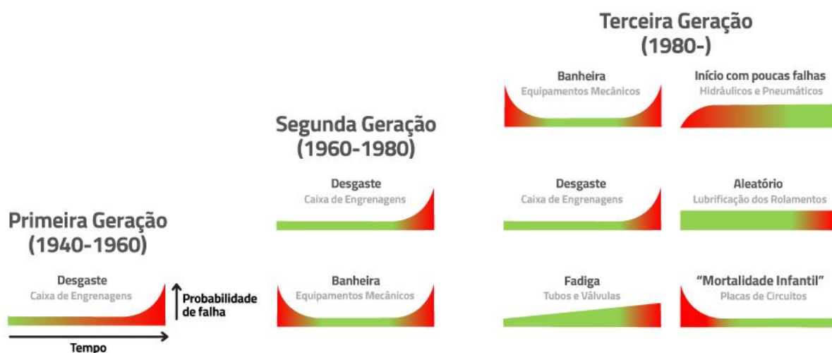
Figura 3 - Padrões de falha por geração. Fonte: Fersiltec, (2017).
