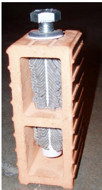
Fotografia 9 – Fixação por adesão Química
