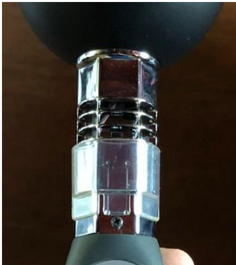
Fotografia 14 – Sensor do Termômetro Aberto
