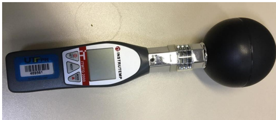
Fotografia 12 - Termômetro Globo ITWTG-2000
