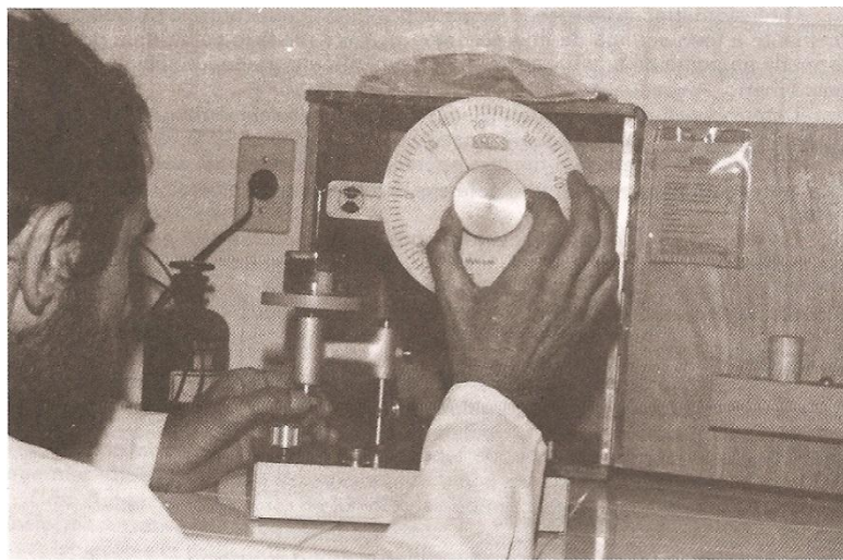
Figura 11 - Tensiômetro para medir tensão interfacial Fonte: Milasch, 1998
