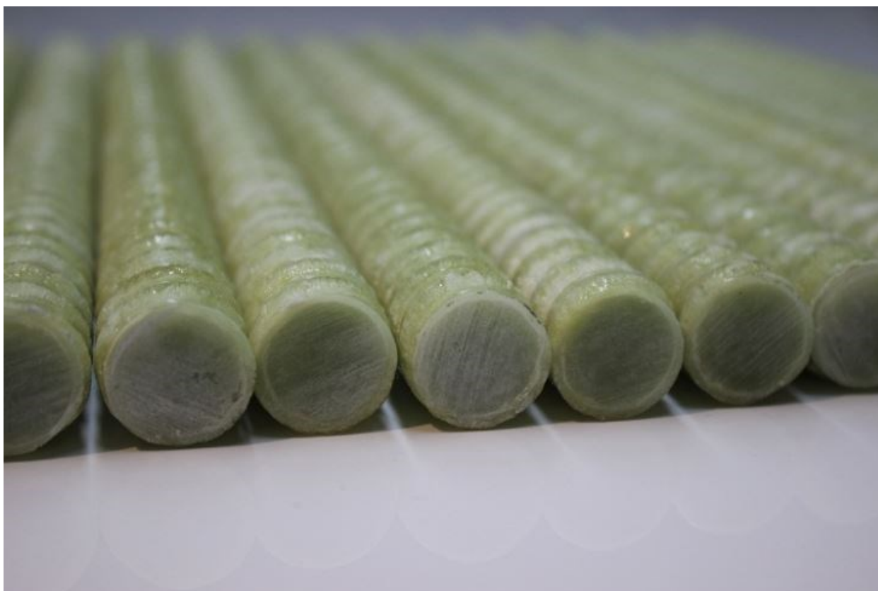
Figura 3 - Barras de fibra de vidro (GFRP)
