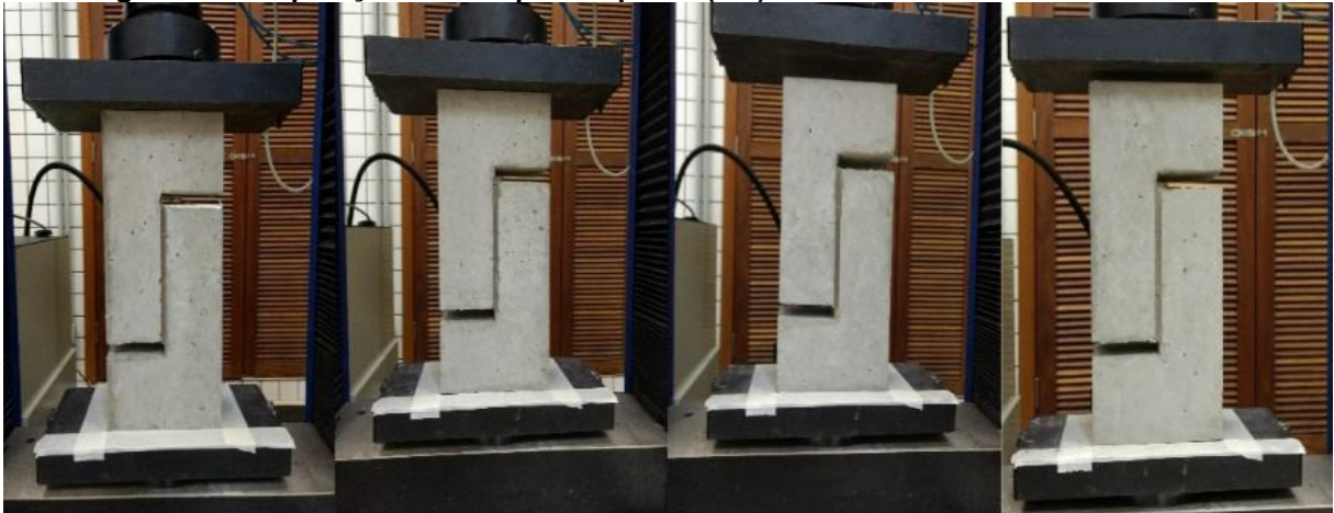
Figura 10 - Disposição dos corpos de prova (CC) no ensaio de cisalhamento direto.
