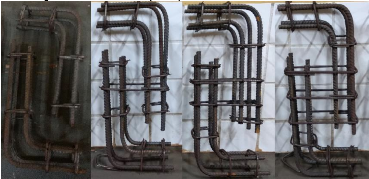
Figura 9 - Armaduras nos corpos de prova do ensaio de cisalhamento direto.
