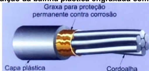
Figura 3 - Constituição da bainha plástica engraxada com fios de aço.
