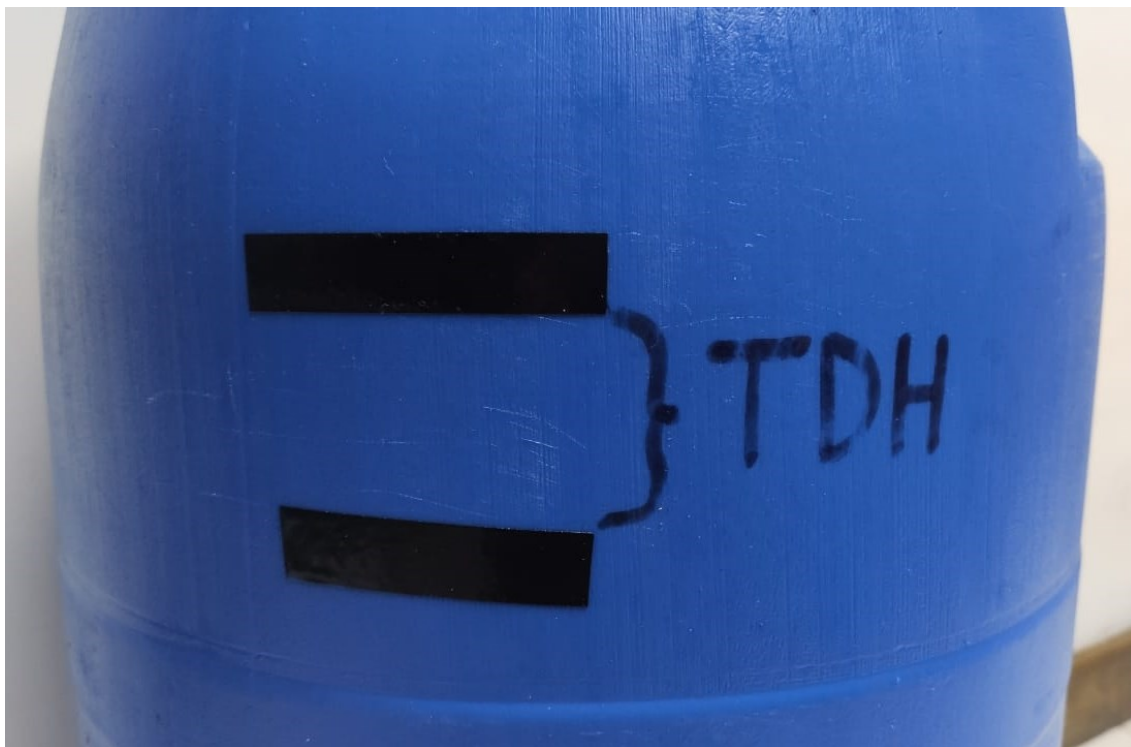
Imagem 11 - Tambor utilizado para execução dos ensaios. Representação das marcações utilizadas para controle do nível de mistura afluyente
