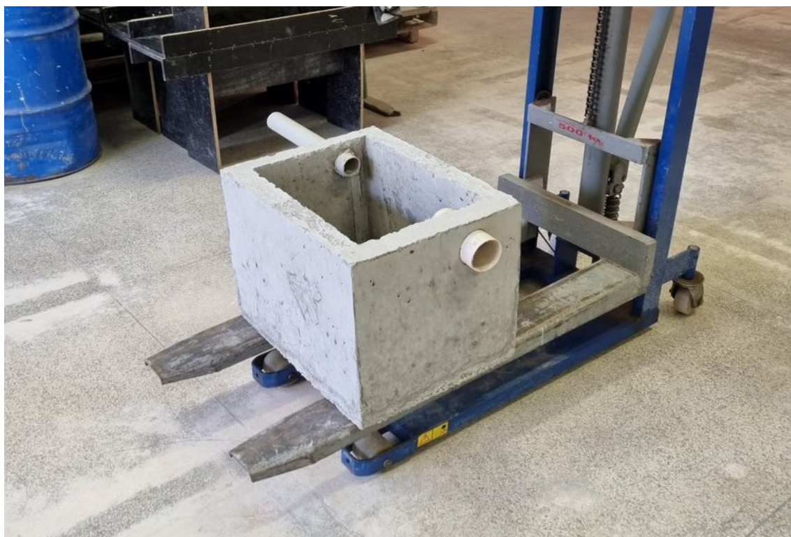
Imagem 7 - PCG após a retirada das formas
