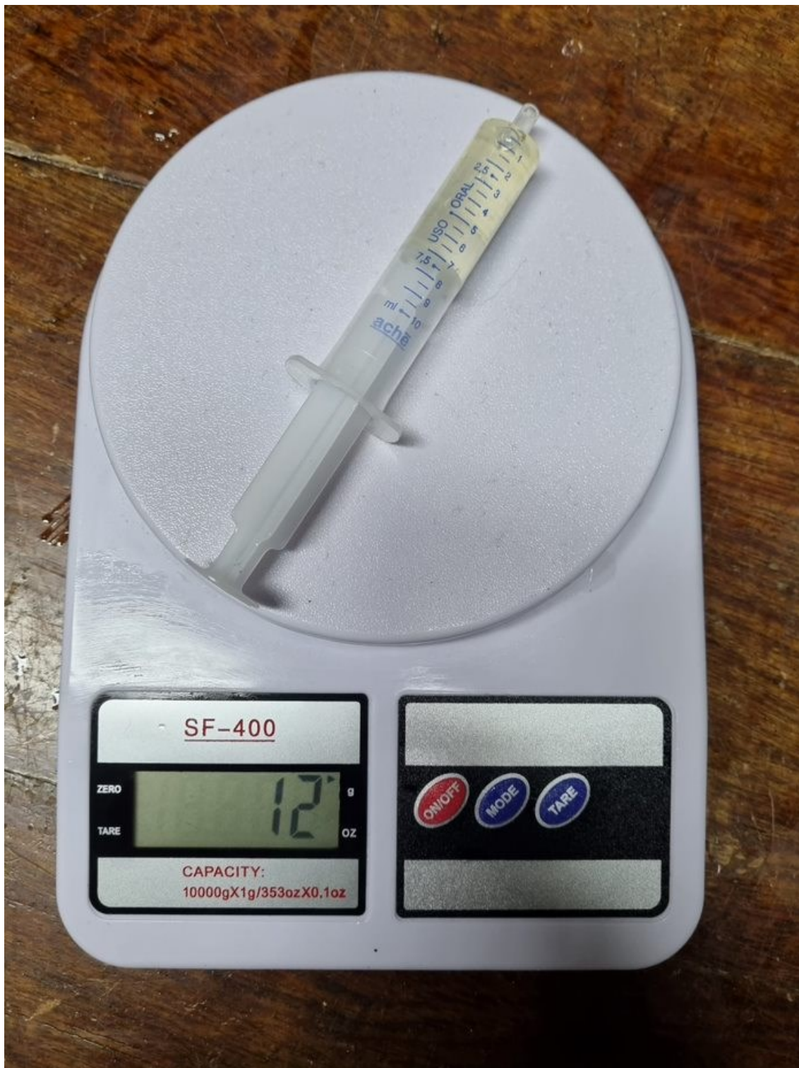
Imagem 13 - Seringa utilizada na extração do óleo na superfície da mistura para posterior pesagem
