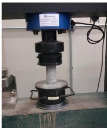
Figura 16 - Corpo de prova no ensaio de resistência à compressão
