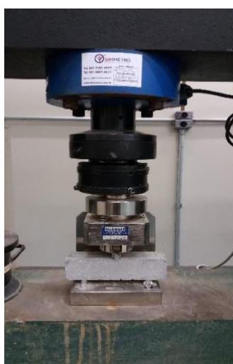
Figura 17 - Corpo de prova no ensaio de resistência à flexão
