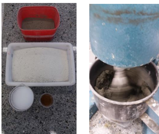
Figura 13 - Etapas de preparação da argamassa
