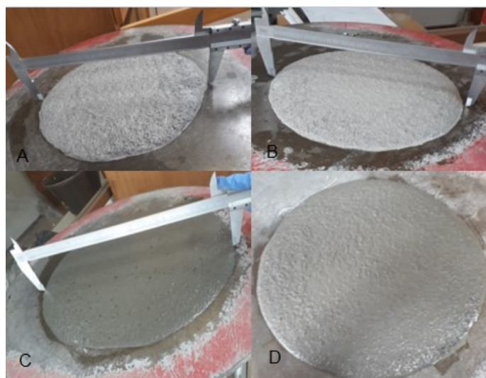
Figura 29. Caracterização do espalhamento das argamassas. A= CSS85/ B= CSS75/ C= CP V/ D= CPIV. Fonte: Pessoal.
