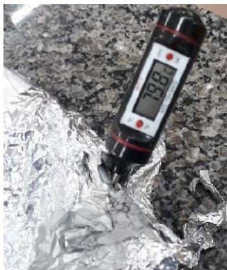
Figura 34. Medição da temperatura da solução de NaOH realizada durante a leitura das barras.
