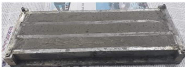
Figura 30. Barras prismáticas de argamassa moldadas para o ensaio de expansão.
