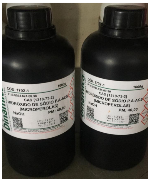
Figura 28. Produto empregado para preparo da solução de NaOH no qual as argamassas foram submersas durante o ensaio.
