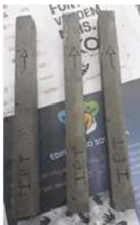
Figura 32. Prismas de argamassa desmoldados para o ensaio de expansão. Fonte: Pessoal.
