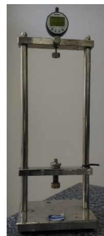
Figura 31. Relógio comparador utilizado para realização das leituras das barras. Fonte: Pessoal.
