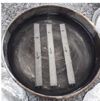
Figura 33. Barras de CSS em solução de NaOH em recipiente de aço inox na estufa. Fonte: Autor, 2021.
