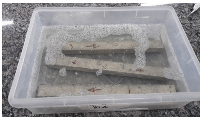
Figura 35. Barras do ensaio de expansão transferidas para recipiente plástico aos 42 dias de ensaio, quando foram retiradas da estufa.
