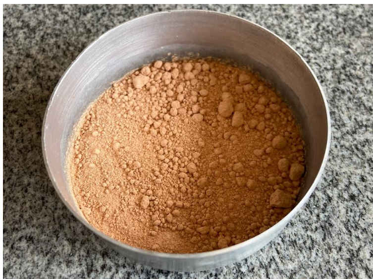
Fotografia 1 - Amostra do resíduo cerâmico moído
