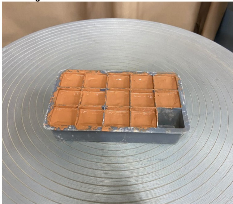
Fotografia 3 - Pasta de cimento adensada em molde
