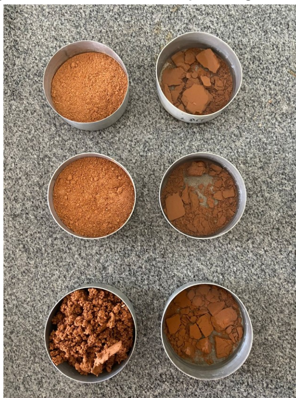
Fotografia 5 - Resíduos de cimento pós secagem em estufa
