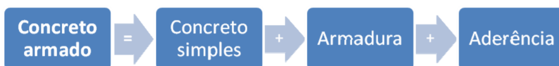
Figura 1- Fluxograma do esquema do concreto armado.
