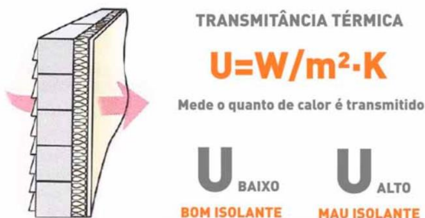
Figura 5 – Esquema representativo transmitância térmica
