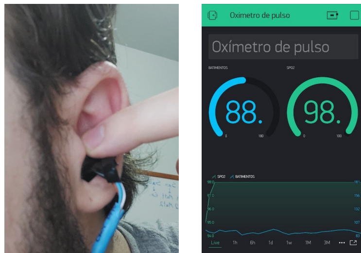
Figura 19: Posicionamento do sensor e interface Blynk. (a) Posicionamento do sensor (b) Aplicativo Blynk
