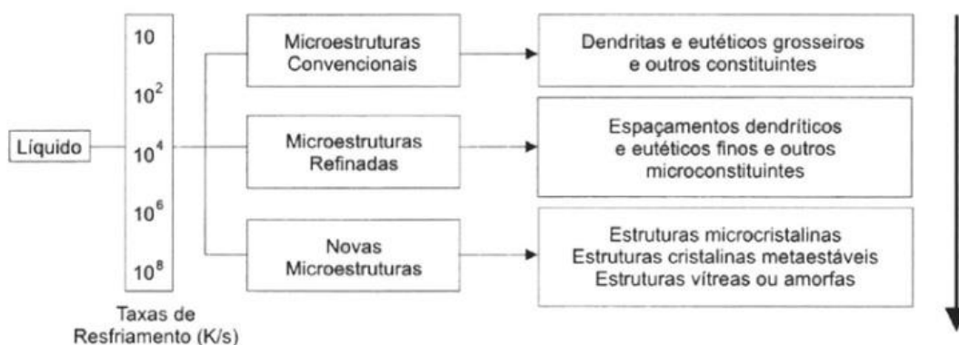
Figura 2 - Influência da taxa de resfriamento sobre a microestrutura de solidificação.
